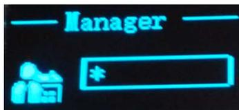
Рисунок 3 – Вход в режим администратора панели замка WF-011. Для получения доступа в меню функций, авторизуйтесь в качестве администратора (приложите палец или введите пароль и нажмите #).
