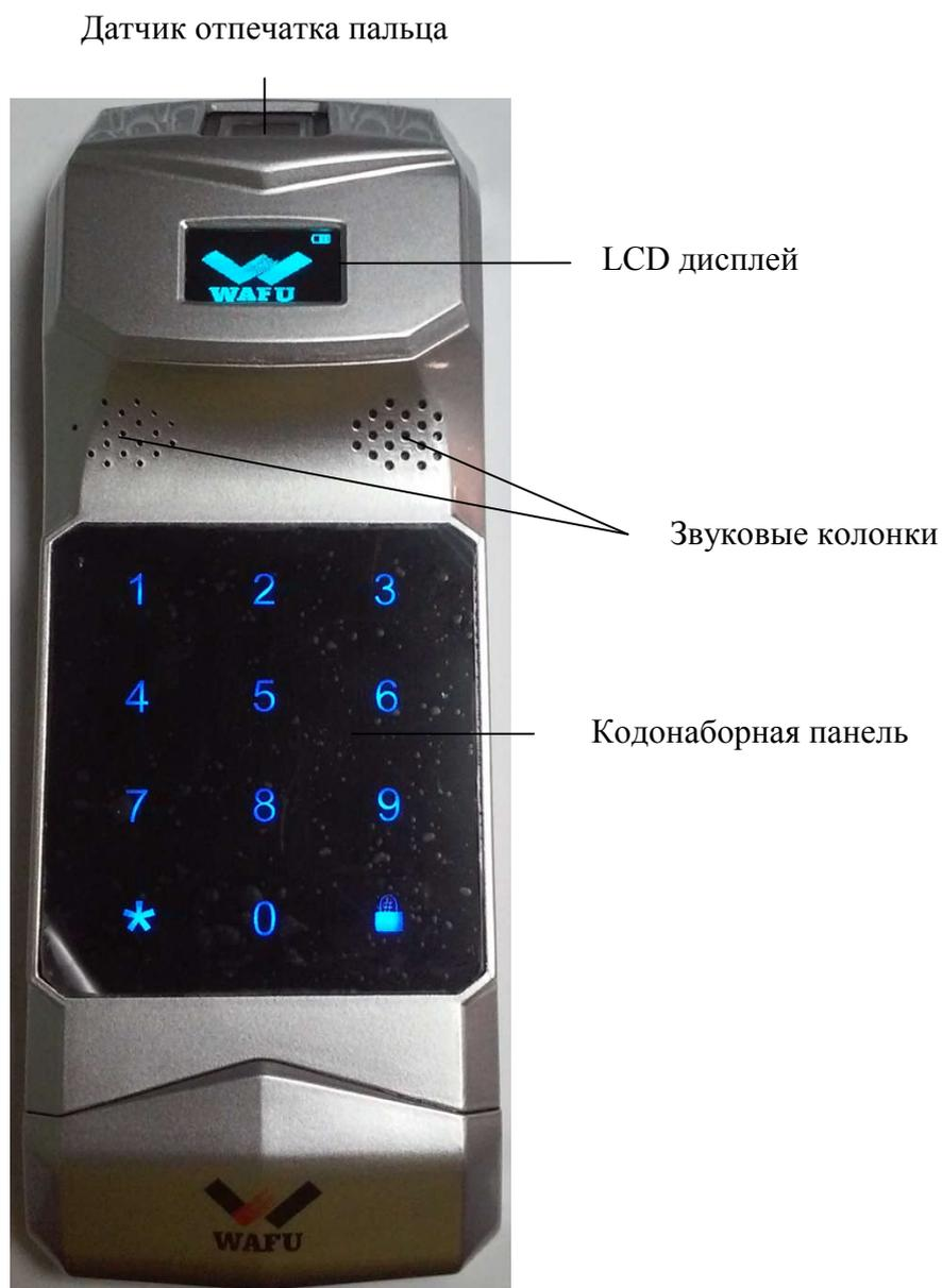
Рисунок 2 – Кодонаборная панель замка WF-011
